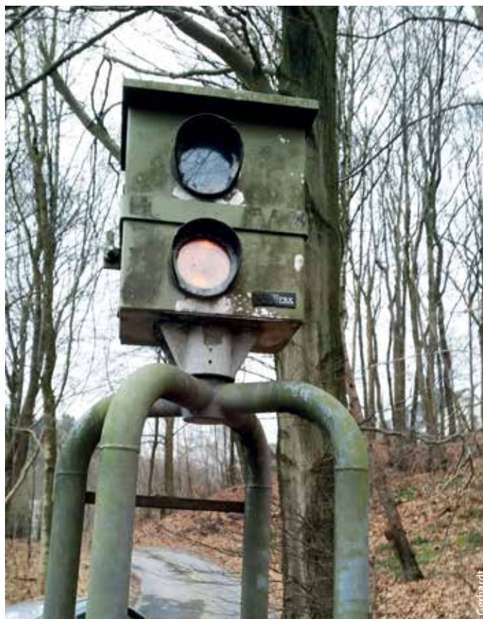
> Ein Dinosaurier der Geschwindigkeitsmesstechnik – herkömmlicher „Starenkasten“. Moderne Geschwindigkeitsüberwachungsanlagen sind nicht räumlich gebunden und können daher sehr flexibel eingesetzt werden!
