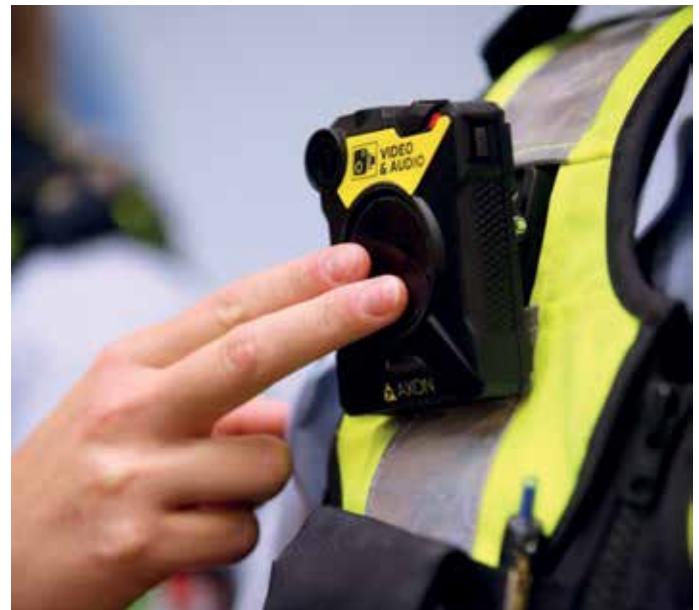
> Die Aufnahme lässt sich durch zweimaliges Drücken der Ereignistaste aktivieren. Ein nochmaliges Drücken für einen längeren Zeitraum beendet die Aufnahme. Die Handhabung der Bodycams ist durchaus einfach.
