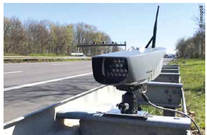
> Kennzeichenlesegerät der Firma Jenoptik für den mobilen Einsatz: Vector ANPR (AUTOMATIC NUMBERPLATE RECOGNITION)
